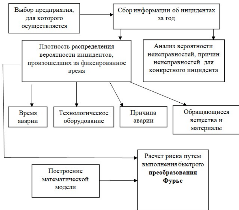
Рисунок 2 – Алгоритм расчета пожарного риска на нефтеперерабатывающем предприятии с использованием быстрого преобразования Фурье
