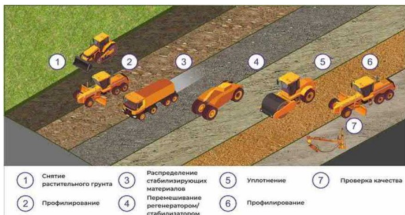
Рисунок 1 – Схема процесса стабилизации грунта
