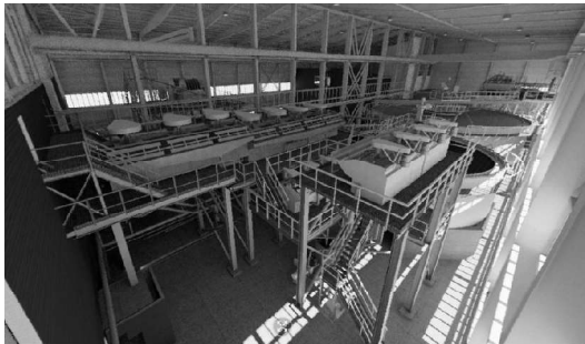
Рисунок 2 – BIM-модель завода, построенная по данным лазерного сканирования
