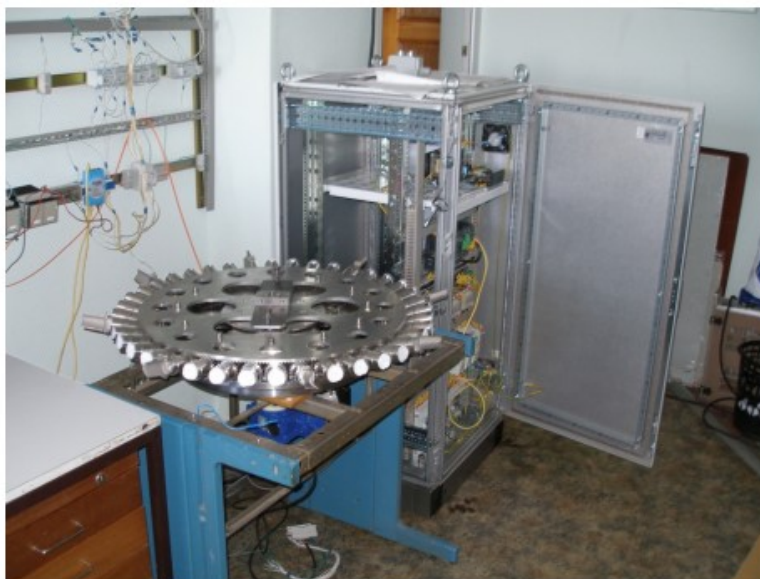
Рисунок 1 - Внешний вид устройства для закрепления лопаток в установке «ГЕЗА-ММП»
