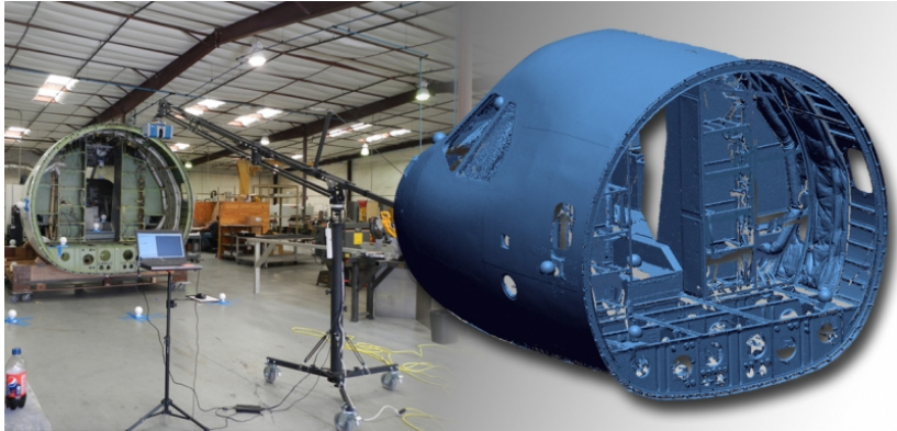
Рисунок 6 – Сканирование части самолета
