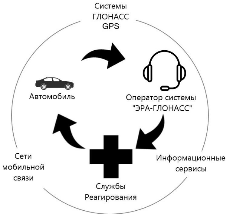
Рисунок 1 – Схема работы системы ЭРА-ГЛОНАСС
