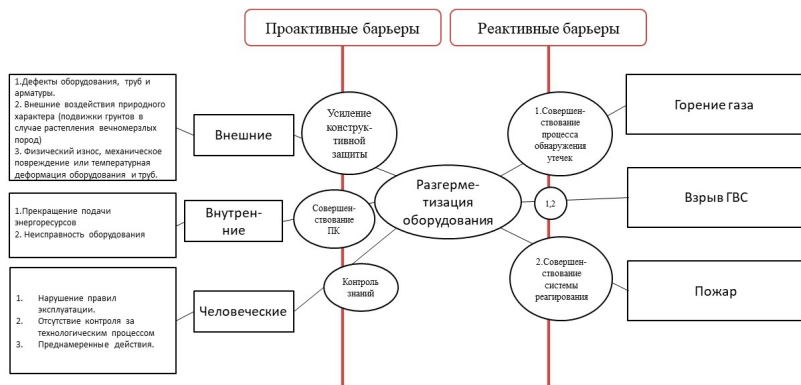
Рисунок 1 – Схема «галстук-бабочка» на примере УКПГ Ямсовейского месторождения
