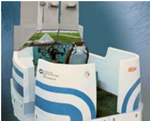
Рисунок 1 – Кабина одноместного авиационного тренажёра с тремя безочковыми 3D-индикаторами производства ОАО ПКБМ (г, Пенза).
