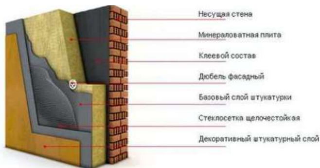
Рисунок 2 – Устройство мокрого фасада
